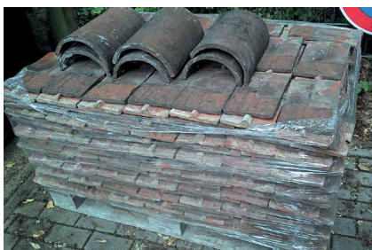
Abb. 13: Gereinigte und zwischengelagerte Dachziegel
